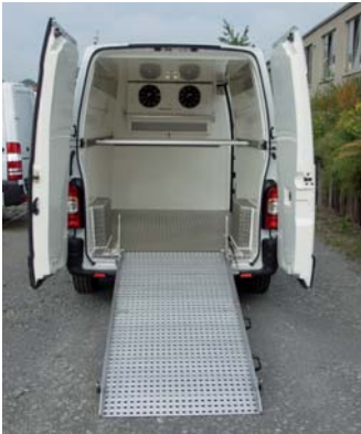
Eine Laderampe erleichtert das Be- und Entladen von Ware: Opel Movano mit Laderampe.
