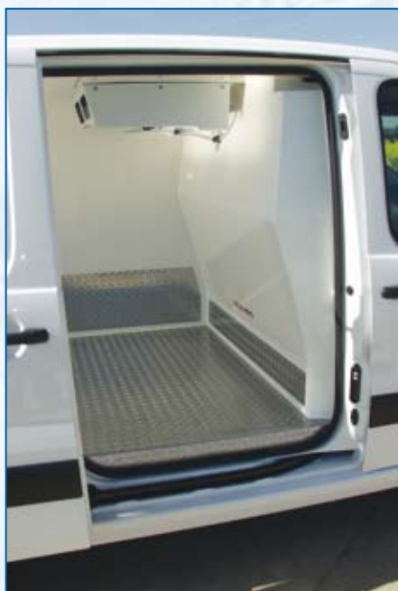
Eingelassene Sockelscheuerleisten an den Radkästen und Wänden gegen Mehrpreis lieferbar.
